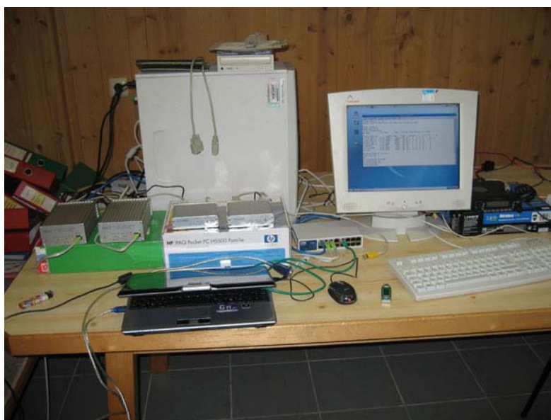
Moderne PR-Knotenrechner wie der DLC verstehen IP und AX over IP (XNET) Im Versuchsaufbau mit HAMNET
