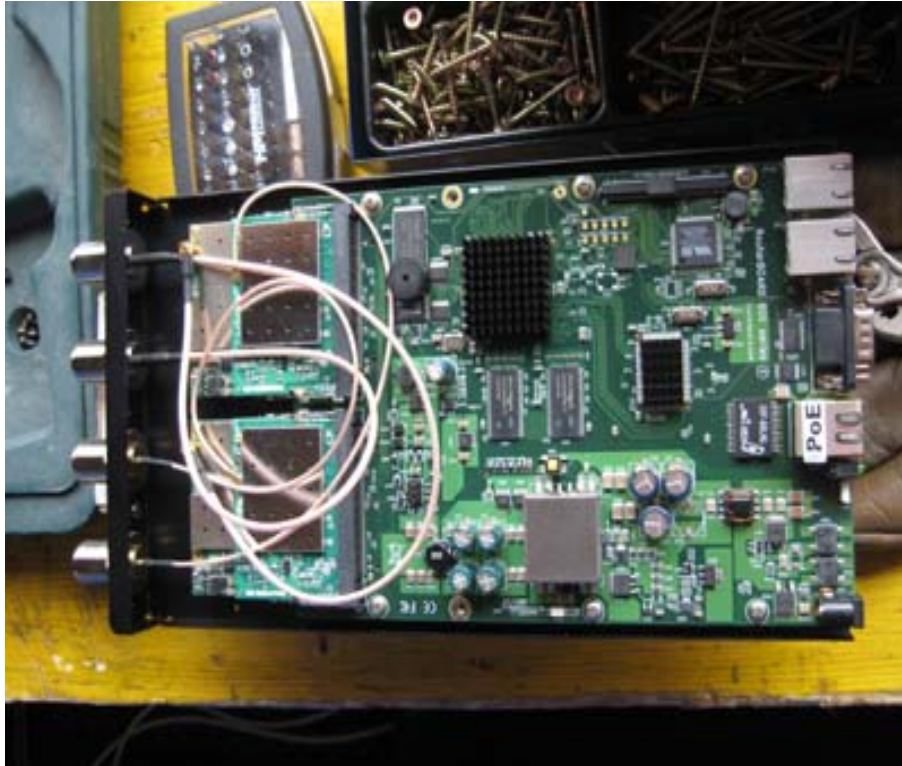
Mikrotik Routerboard 600er Series, eingesetzt am OE7XGR
